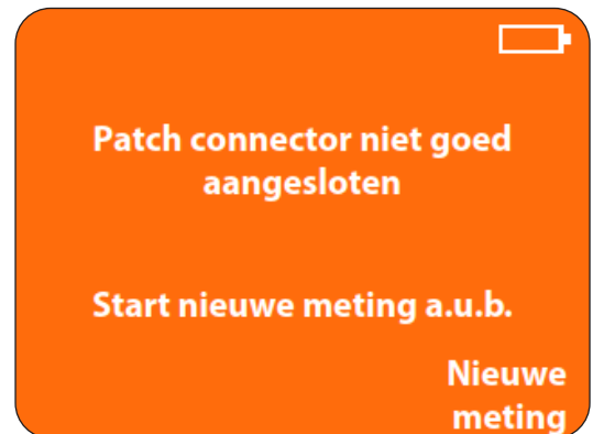
Figuur 29: De Patch connector is losgeraakt. U dient een nieuwe meting te starten.
