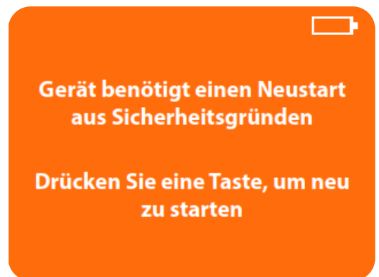
Abbildung 34: Auf dem Bildschirm des Monitors wird angezeigt, dass das Gerät nach dem Laden neu gestartet werden muss.
