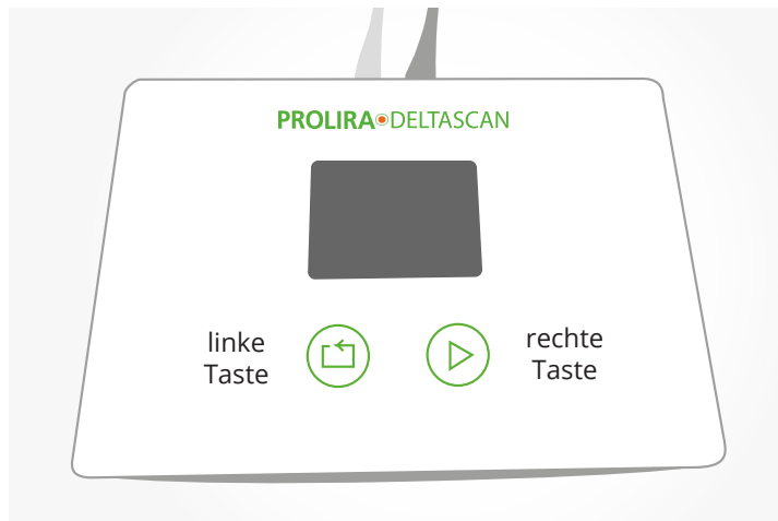
Abbildung 5: Position der beiden Tasten auf dem Monitor.
