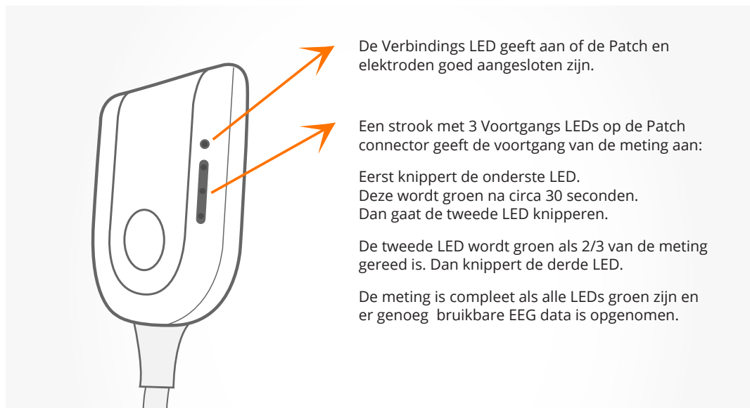
Figuur 26: Een strook van LEDs op de Patch connector toont de voortgang van de meting.
