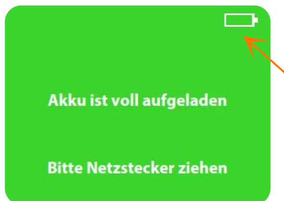
Abbildung 33: Der Bildschirm des Monitors zeigt an, dass der Akku vollständig aufgeladen ist.
