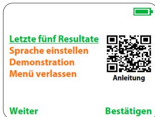
Abbildung 36: Monitorbildschirm des Gerätemenüs (erscheint nach gleichzeitigem Drücken beider Tasten für 3 Sekunden).
