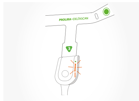
Figuur 25.a: Als de gebruiker de opnameknop loslaat, pauzeert de meting. De strook met LEDs in de Patch connector knippert oranje.
