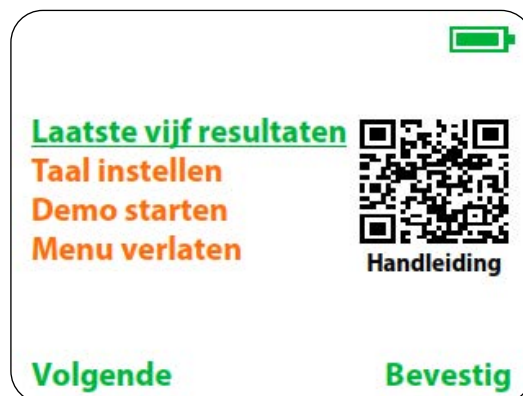
Figuur 36: Monitor scherm met het menu, dat beschikbaar komt door gelijktijdig de linker en rechter-toets op de Monitor 3 seconden lang ingedrukt te houden.
